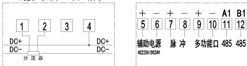
图 5：电流间接接入式（三线、负极性接入）
