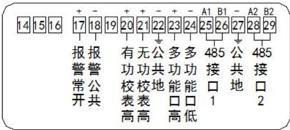
图 7 三相四线直接接入式接线图（3×220/380V）
