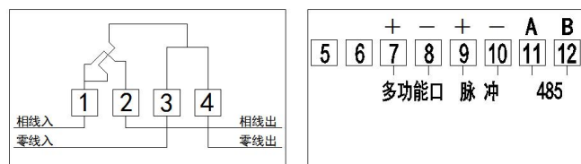
图 4：单相智能电能表端子接线图（内置负荷开关）
